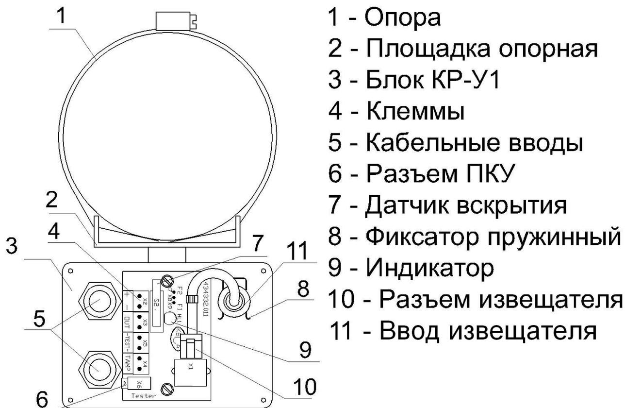
Рисунок 1.3 - Расположение и маркировка органов управления
